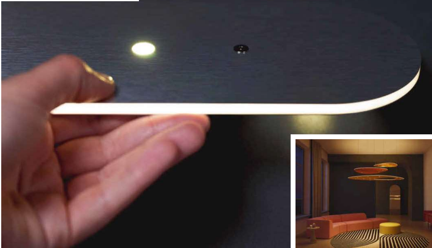
/ Individuelle Leuchtkörper: In einer „Licht-Maßschneiderei“ werden Bauteile, LEDs und Treiber sowie weitere Steuerungselemente in einer 6 mm starken Sandwich-Platte digital gestützt platziert.
